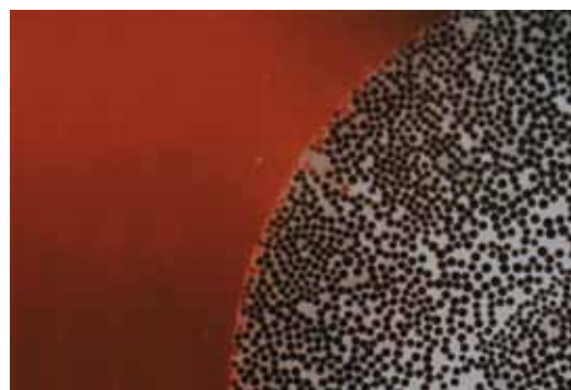
Dichte Verteilung der Glasfasern in der Harzmatrix bei Rebilda Post (CLSM-Aufnahme) Prof. Dr. D. Behrend, Universität Rostock
